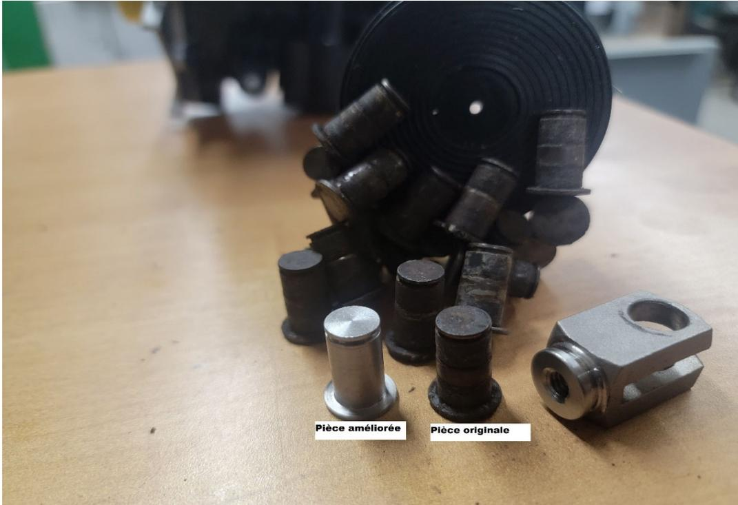
Le pivot pour la soupape de décharge:
