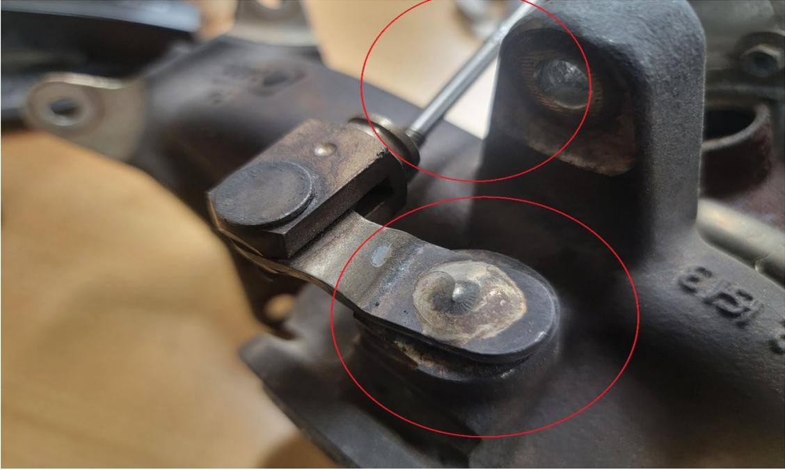
La soupape de décharge vu de l'extérieur. À gauche la tige, à droite le pivot vu de l'extérieur.
