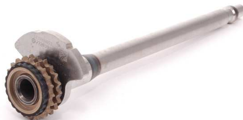
Photo R-2 – Arbre de balancement des moteurs V6 M272
